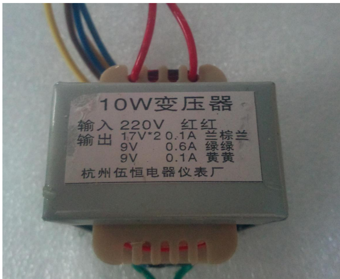
图 2-2 EI 变压器示意图
